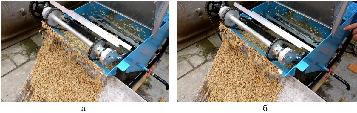
Рисунок 1. Общий вид рабочего процесса опытного образца машины МВС-1,0 для выделения ядовитых примесей из зерна озимой ржи: а – при удельной зерновой нагрузке q_{\text{зд}} = 67,377 \text{ кг}/(\text{с} \cdot \text{м}^2) ; б – при удельной зерновой нагрузке q_{\text{зд}} = 143,553 \text{ кг}/(\text{с} \cdot \text{м}^2)
