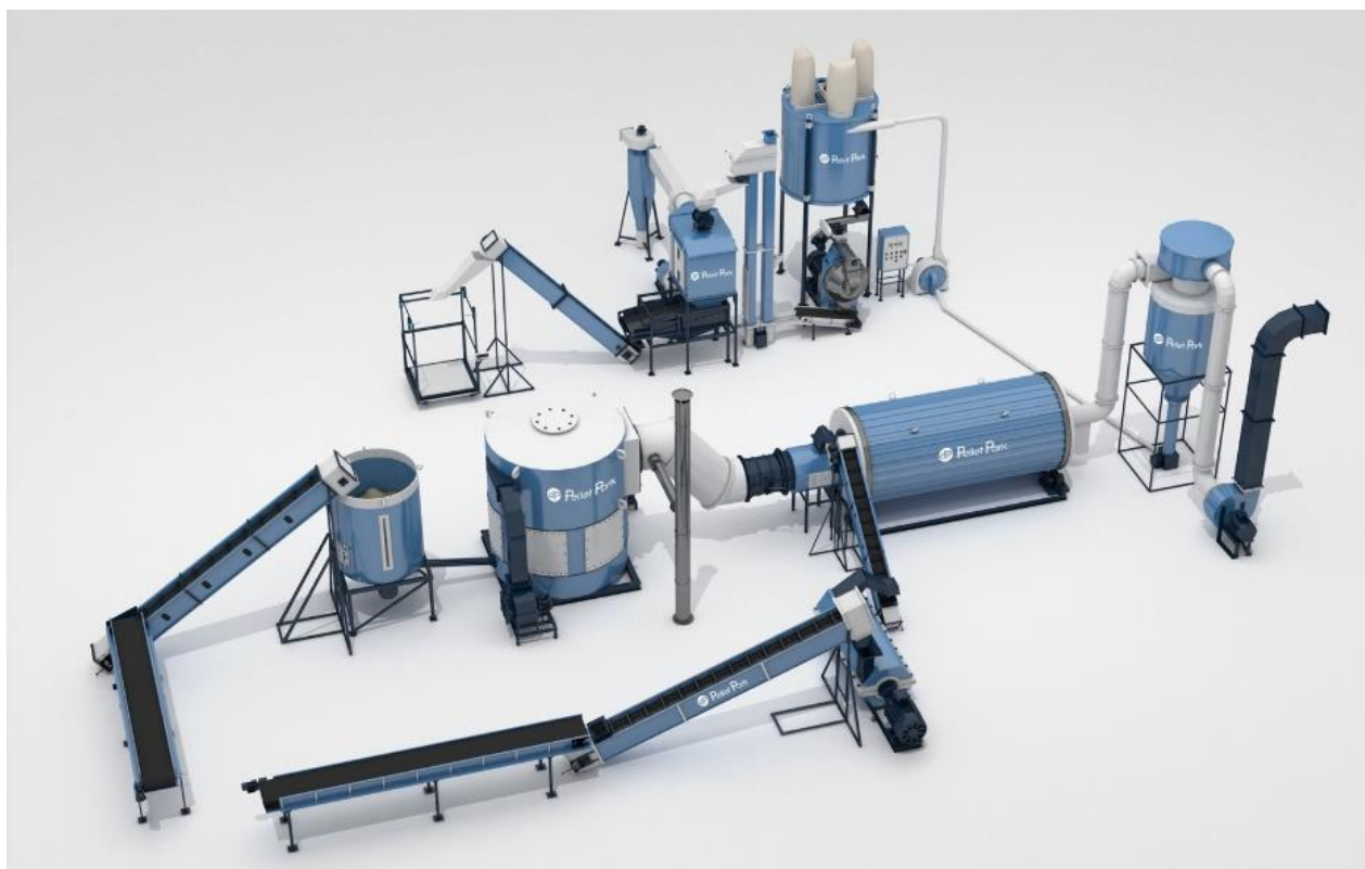
Рисунок 1. Схема технологической линии Pellet Park по производству пеллет
