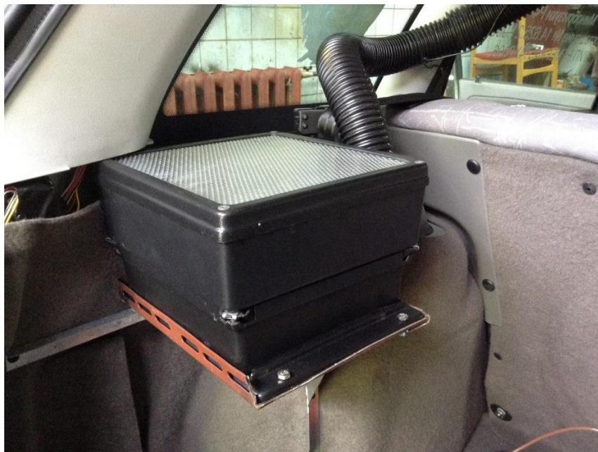
Рисунок 3. Компоновка системы очистки воздуха в багажном отсеке БТСЭТ
