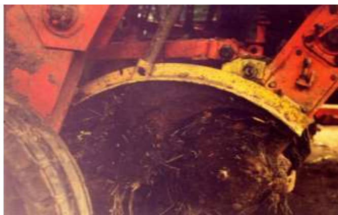
Рисунок 8. Общий вид сошниковой группы дернинных сеялок СДК (а) и фото забивания подкожухового пространства фрезерной секции сеялки СДКП-2,8М (б):
