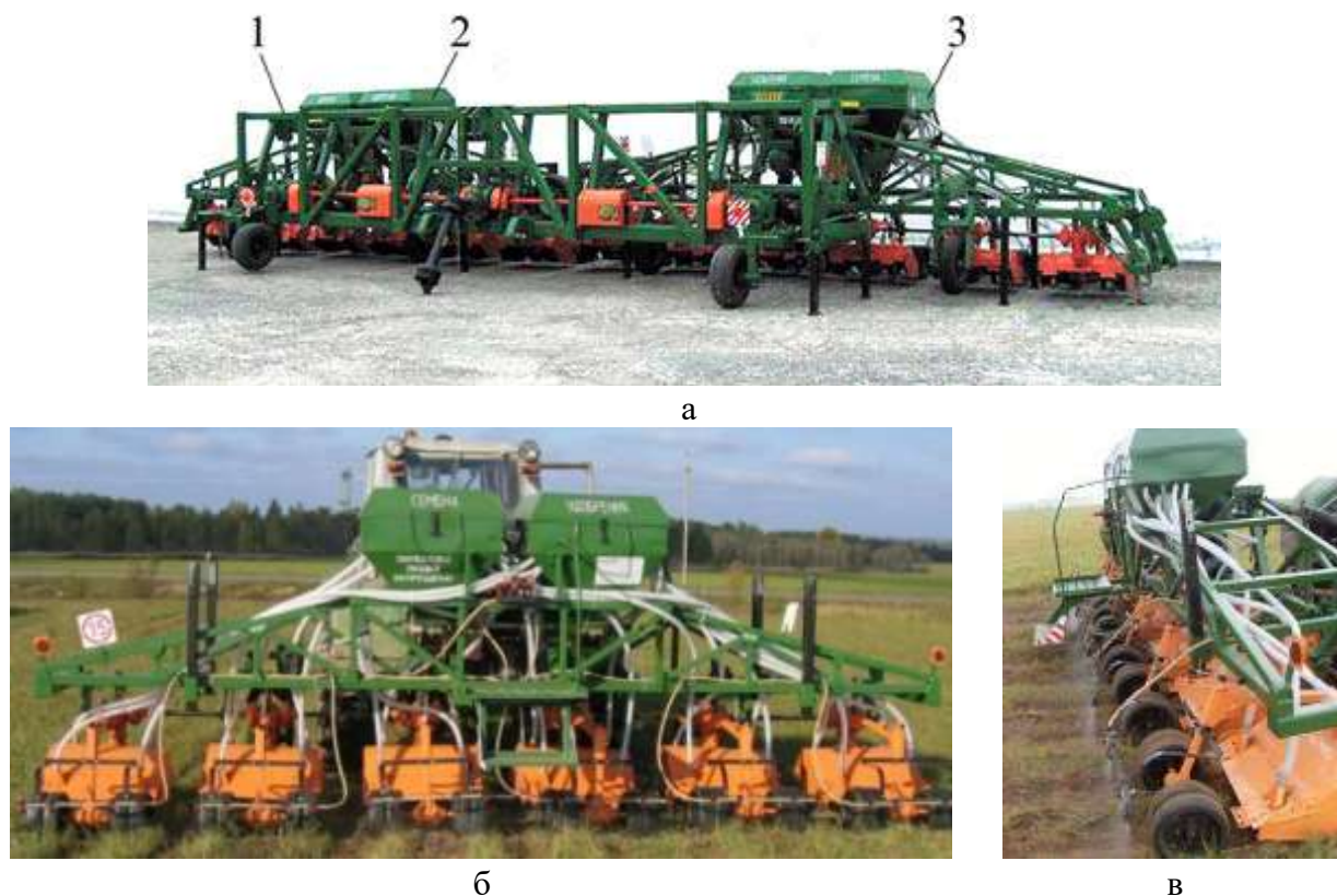
Рисунок 7. Агрегаты для посева трав в дернину МПТД-12 (а) и МПТД-6 (б, в):
