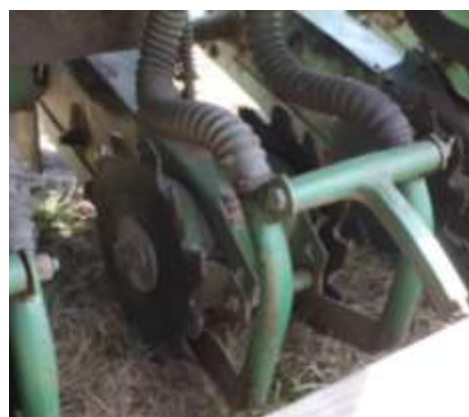
Рисунок 2. Сошниковая группа сеялки John Deere 1500 POWR-TILL:
