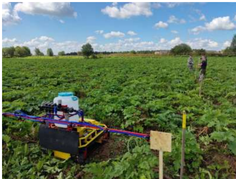
Рисунок 8. Полевые испытания платформы с опрыскивателем
