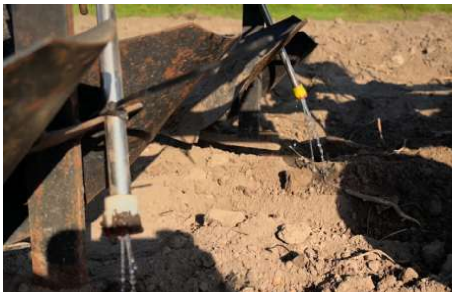
Рисунок 4. Процесс внесения жидких минеральных удобрений внутрипочвенным способом
