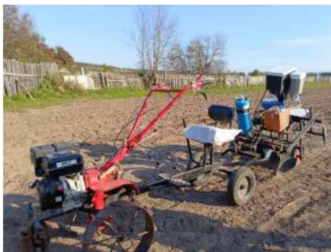
Рисунок 2. Малогабаритный агрегат для внесения жидких минеральных удобрений на испытании
