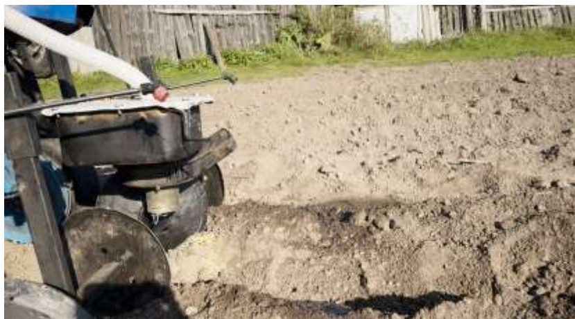
Рисунок 5. Заделка борозды с помощью дисковых окучников
